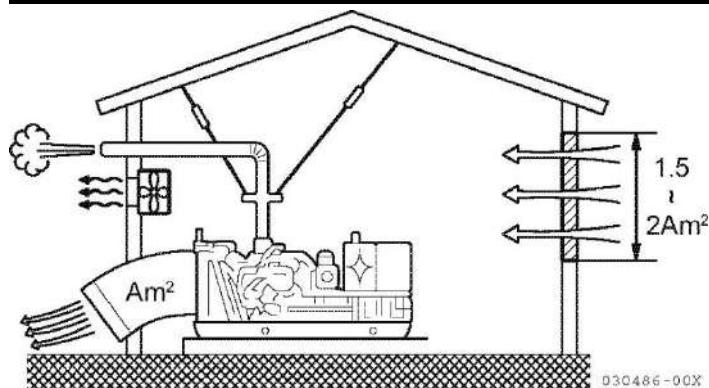
Выхлопной газ двигателя должен полностью отводиться в атмосферу через вытяжную трубу.
