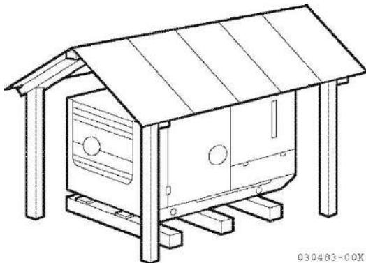
Подушку необходимо приподнимать над полом на соответствующую высоту, чтобы избежать затопления.
